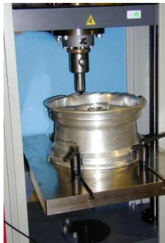
Eindrückversuch an Felgen
