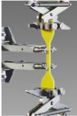
Zugversuch an Normprobe
