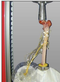
Druckversuch an Knochen
